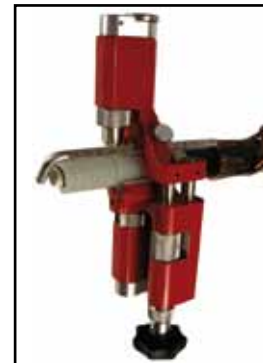
Corte controlado de aislamiento
