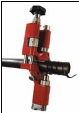
Corte y retiro de cubierta
